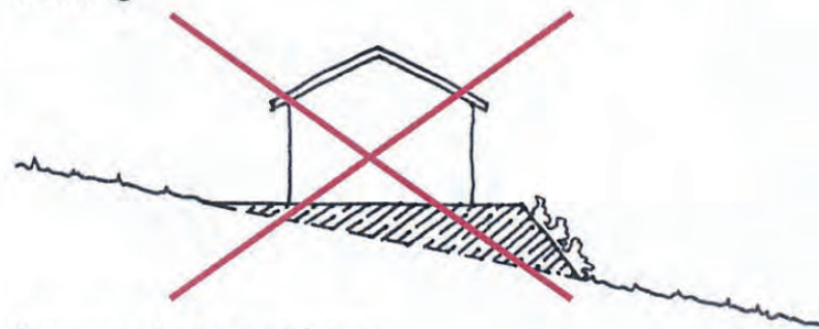
la mise à niveau par talutage
